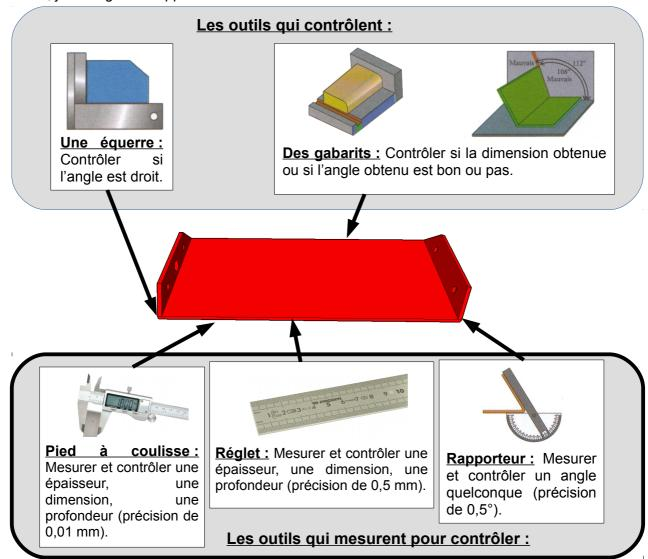
L'écart accepté entre la dimension souhaitée et la dimension obtenue s'appelle la tolérance.
